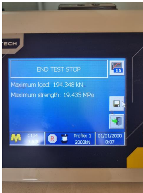
Bilete 8 Dokumentasjon av testresultat (Foto:Allbygg)
