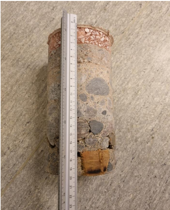
Bilete 10 Kjerneprøve av dekke over gymsal Foto: Christian Støylen, Allbygg
