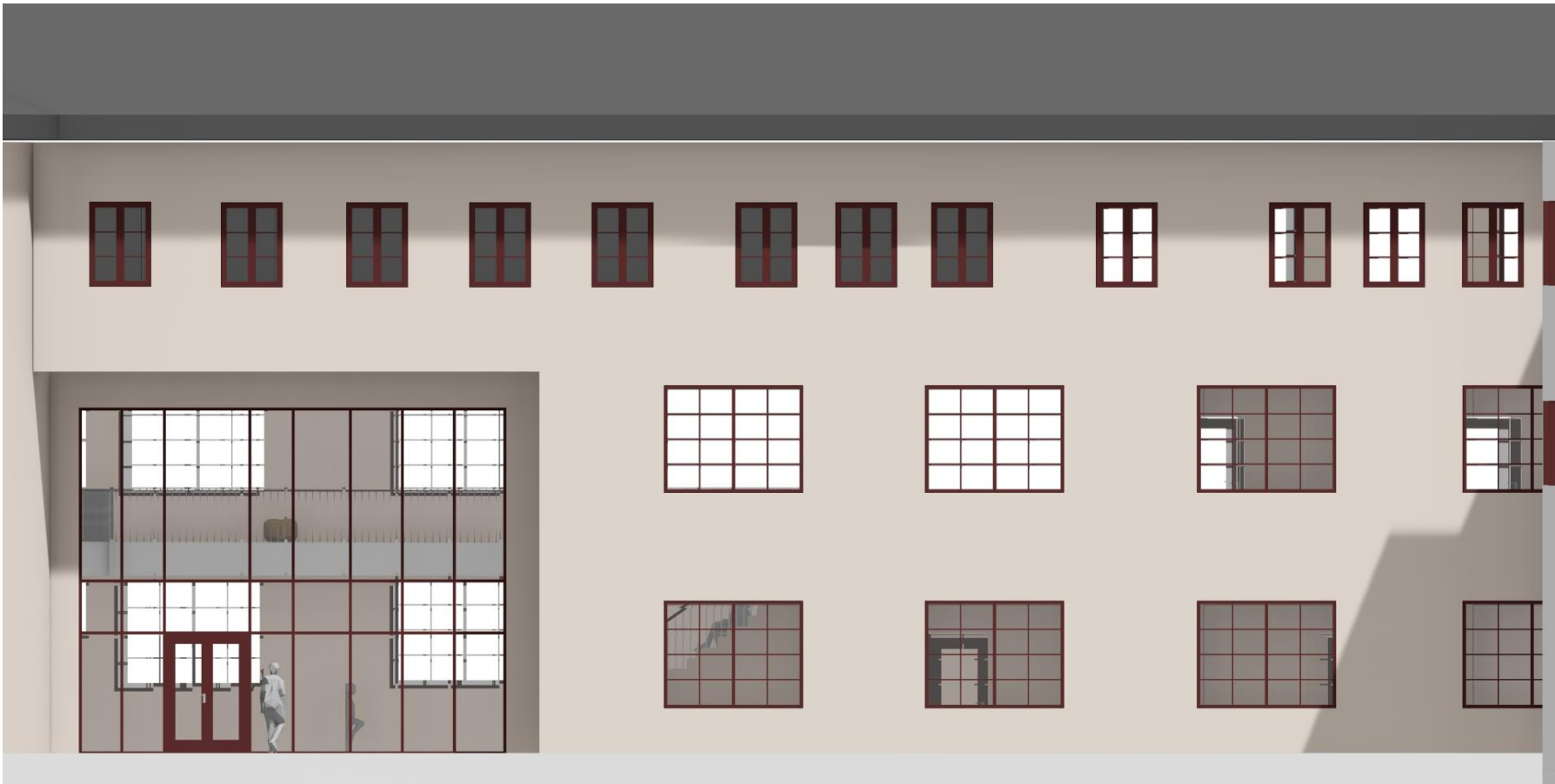
Fasade hovedinngangsparti: økt omfang av vindu og glassfasade for bedre lysinnslipp til aula og for mer transparens og utsikt ut
