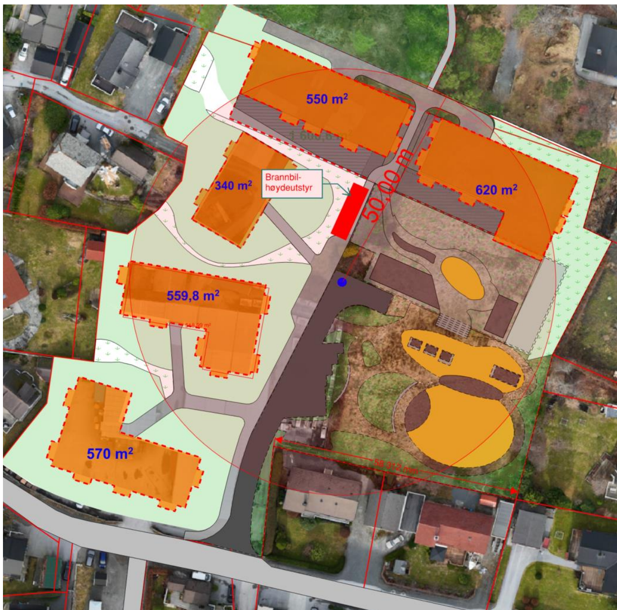
Figur 3: Viser forslag til plassering av ny brannhydrant.
